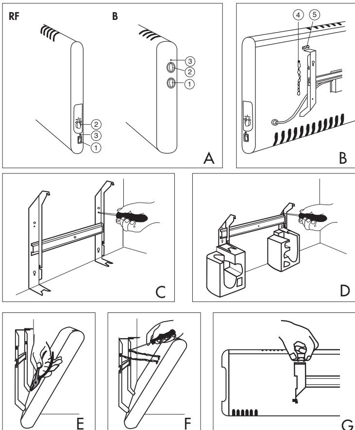
**Figur C** Montering av väggfäste 400 mm hög radiator.
